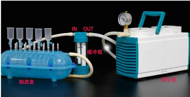
4. 进行核酸提取时，将接头的小口端插入抽滤盒孔中，然后将吸附柱、纯化柱或过滤器等插到接头大口端，不需要用的孔用堵头堵住进行密封，细节如下图所示。
